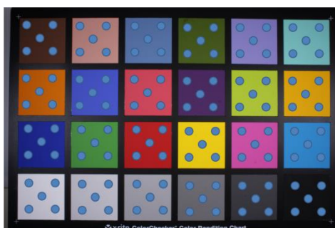
ภาพที่ 3.11 แสดงตำแหน่งการวัดค่าสีด้วย Spectrophotometer
