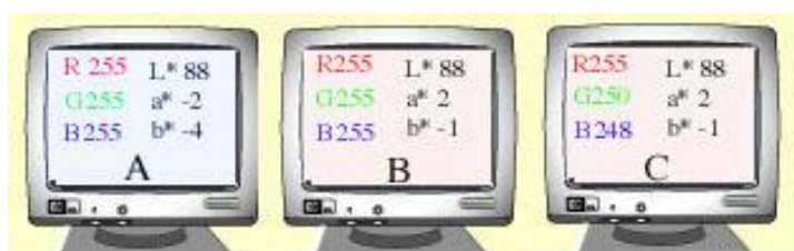
ภาพที่ 2.14 เปรียบเทียบสีอิงอุปกรณ์ (RGB) และสีไม่อิงอุปกรณ์ (CIE Lab)
