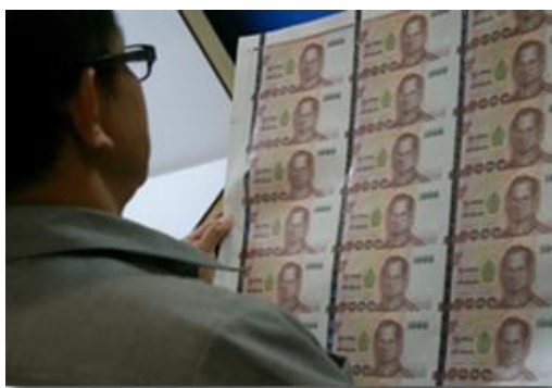
ภาพที่ 1.5 แผ่นพิมพ์ธนบัตรที่ผ่านการพิมพ์เส้นนูน
