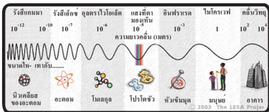
ภาพที่ 2.1 แสดงความยาวคลื่นแม่เหล็กไฟฟ้าในช่วงต่างๆ
