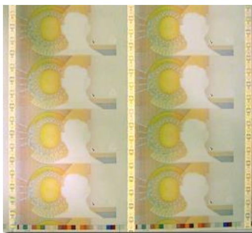
ภาพที่ 1.2 แผ่นพิมพ์ธนบัตรที่ผ่านการพิมพ์สี่พื้นด้านหน้า
