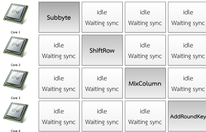
ภาพที่ 3.30 ลักษณะโครงสร้างการทำงาน AES บนหน่วยประมวลผลแบบ synchronization
