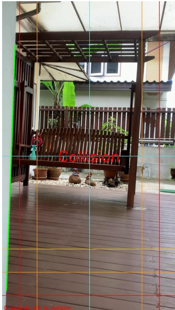
รูปที่ 58 เส้นตรงสีเขียวที่ขอบของสิ่งกีดขวางประเภทที่ไม่ใช้วัตถุ
