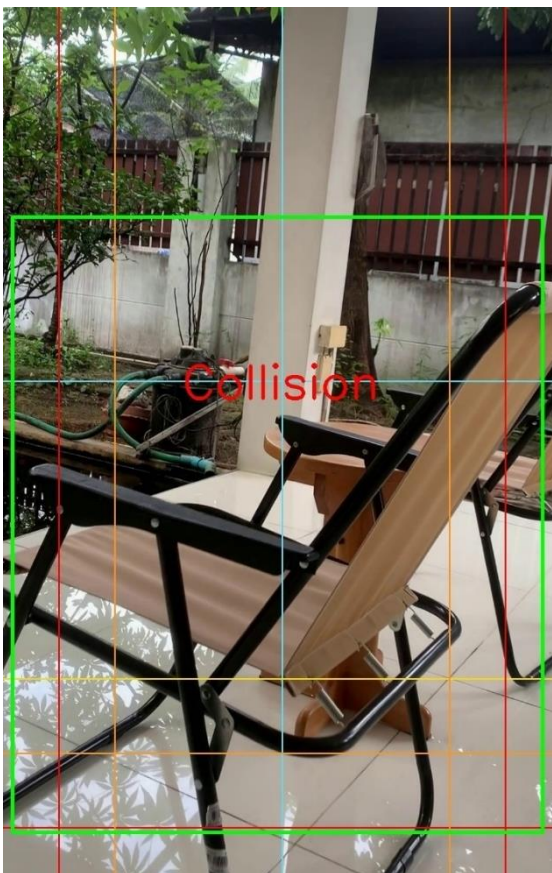
รูปที่ 52 ระบบแสดงข้อความแจ้งเตือนก่อนชน ด้วยคำว่า Collision
